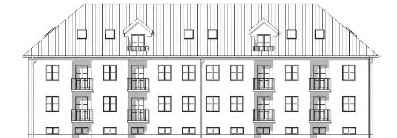
Vestfacade med nye altaner - samtlige blokke
